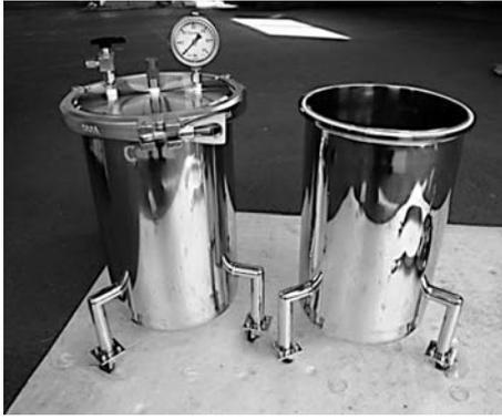
試作された「高圧炭酸ガス処理用容器」
